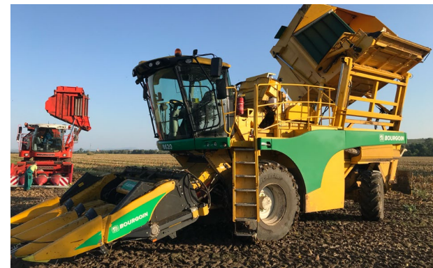
Foto č. 6: Kukuričný kombajn BOURGOIN B620 (v popredí) a jeho stažia verzia JLD410 so 4-riadkovými adaptérmí Geringhoff na zber osivovej kukurice počas prestávky na údržbu.
