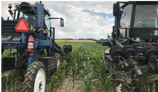
Foto č. 2: Dvojica kastračných strojov zn. FREMA Aiglon. Vľavo zadný, vpravo predný pohľad. Na fotografii vpravo vidíme na adaptéry kastráčne nože a nad nimi valce určené k vytahovaniu zvyškov metlín.
