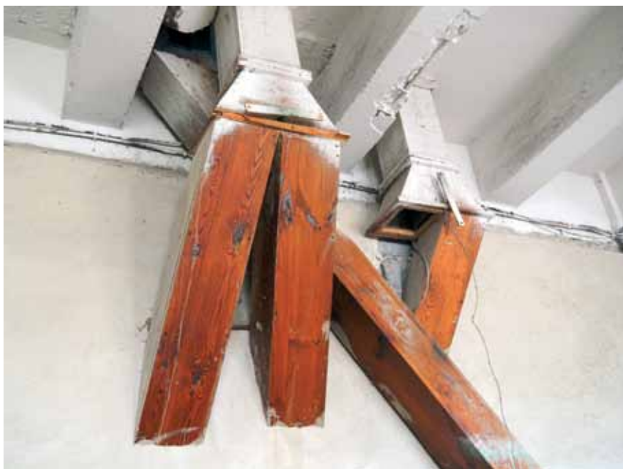
Pohľad na detail historicky vzácných drevených dopravných ciest v suteréne VKZ. Je to súčasť priemyselného dedičstva, ktoré je dokladom vývoja technických diel v oblasti obilných skladísk.
